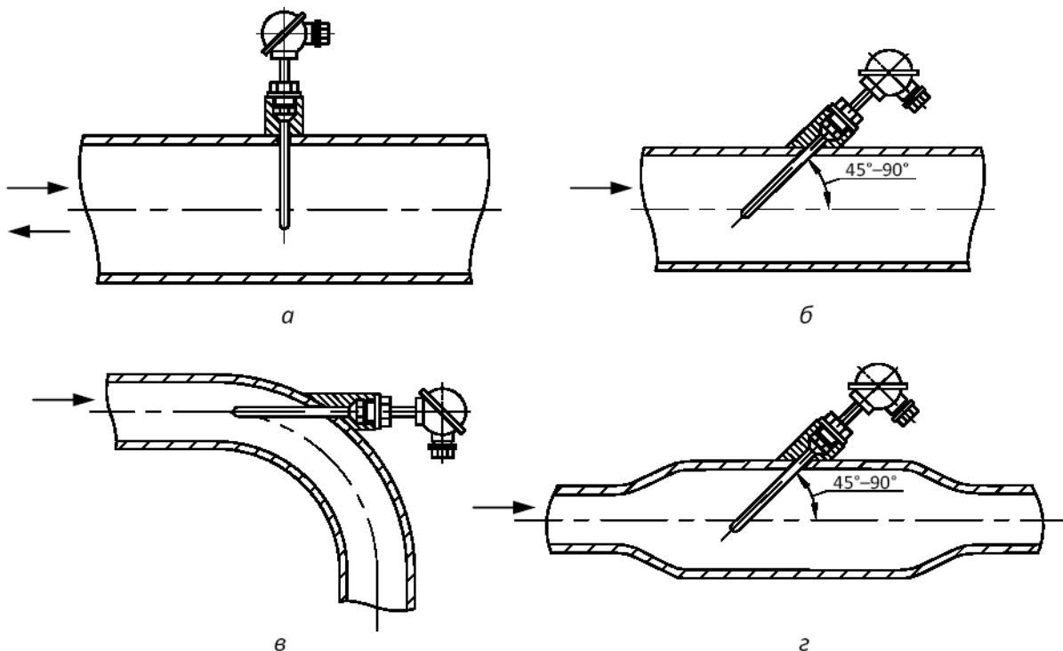
**Рисунок Л.3.1 — Расположение чувствительного элемента термопреобразователя сопротивления:**
