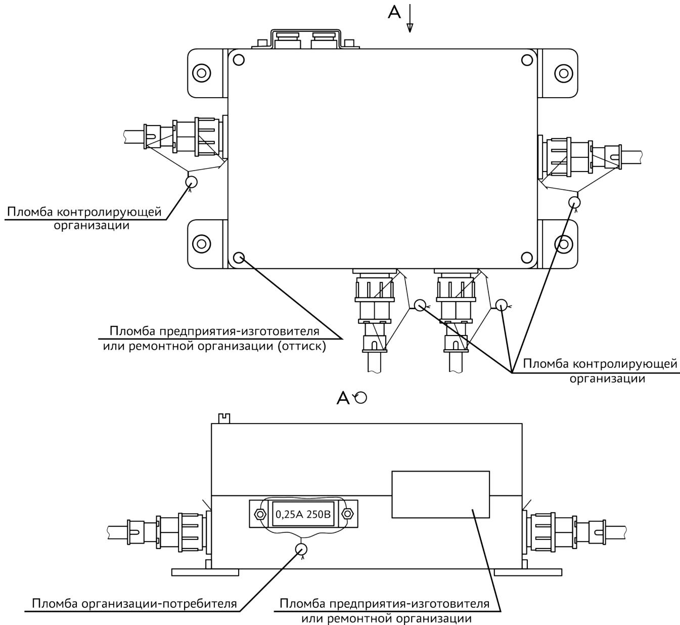
**Ж.2 Схема пломбирования расходомера с Ирга-БП и без датчика давления.**
