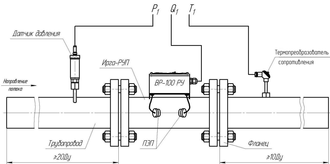
**Л.3 Схема установки термопреобразователя сопротивления.**
