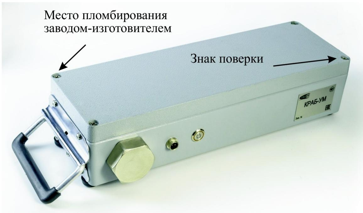
**Рисунок 1 – Места пломбирования и нанесения знака поверки на установки поверочные «Краб-УМ»**
